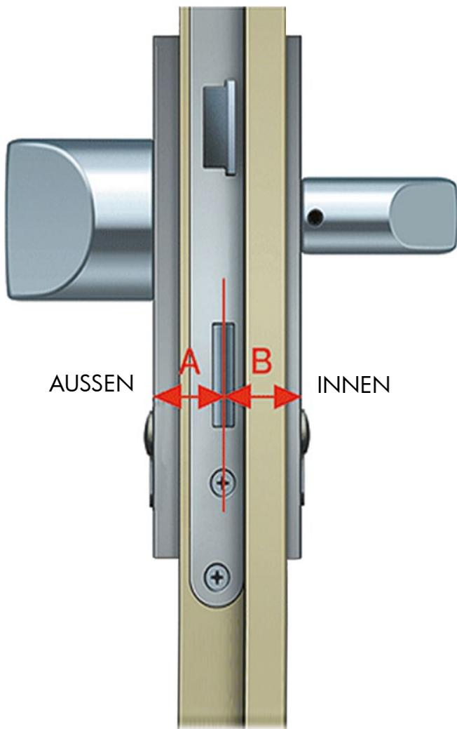
Zylinderlänge AUSSEN (**A**) \_\_\_\_\_
